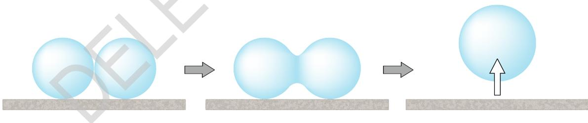
Abb. 1: Vereinigung zweier Wassertropfen und das Hochspringen des vereinigten Wassertropfens.
