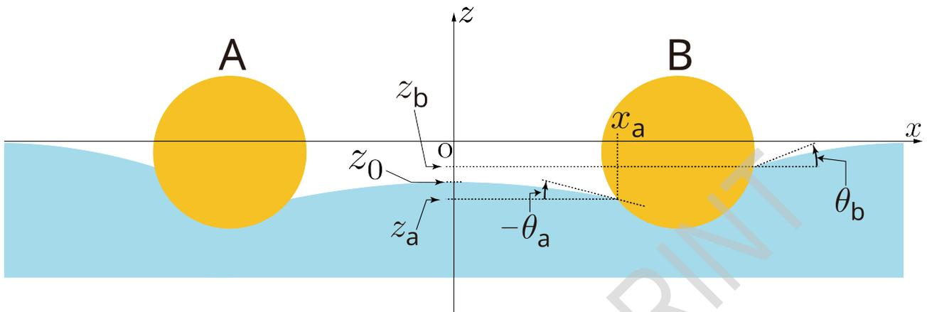
Abbildung 5: Vertikale Seitenansicht (entlang der  $xz$ -Ebene) zweier Stäbe, die auf dem Wasser schwimmen.
