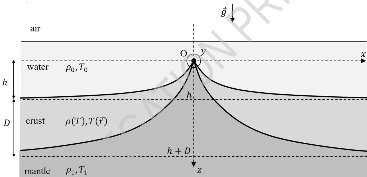
Abb. 2. Mittelozeanischer Rücken. Achtung: Die  $z$ -Achse zeigt hinunter.
