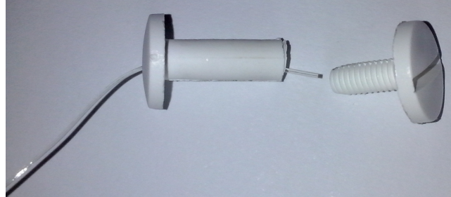
Abbildung 6. Befestigung des TPU-Fadens auf der Halteschraube.
