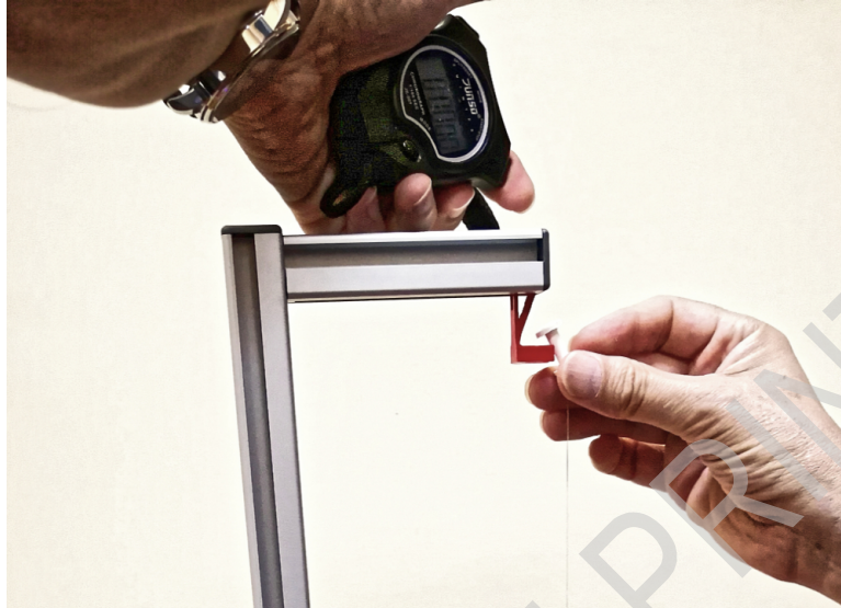
Abbildung 4. Aufhängen des Fadens in die obere Halterung und Start der Messungen.
