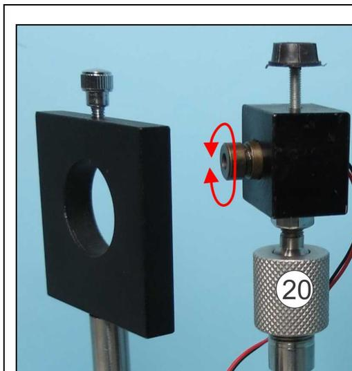
Abbildung 3: Laser und Probenhalter. Laser montiert auf Kugelgelenk [20].
