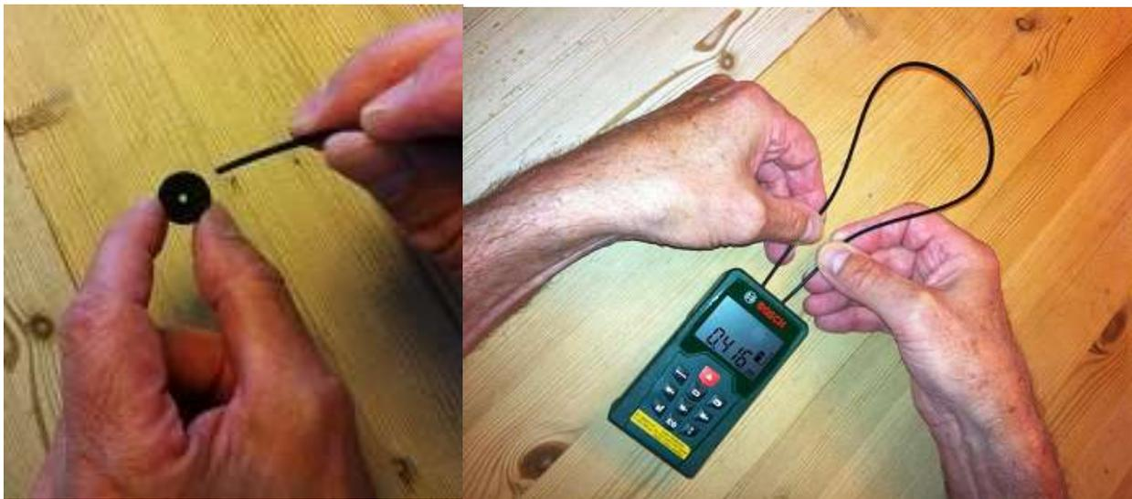
**Abb. 1.5 (a)** Filzaufkleber und Lichtleiter. **(b)** Anbringung des Lichtleiters.
