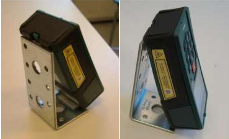
**Abb. 1.8** Befestigung des LDM auf dem Winkeleisen.
