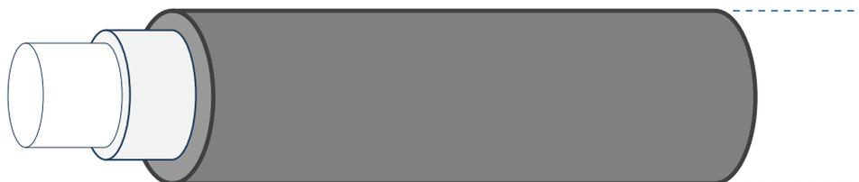
**Abb. 1.4** Aufbau eines Lichtleiters.
