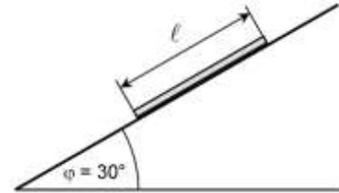
*Hinweis 1:* Man kommt in diesem Beispiel auch ohne sin- u. cos-Funktionen aus, da bei der Dachschräge von  $30^\circ$  eine Gravitationskraft  $G$  in einen parallelen Anteil von  $1/2 \cdot G$  und einen zum Dach senkrechten Anteil von  $\sqrt{3}/2 \cdot G$  zerlegt werden kann.
