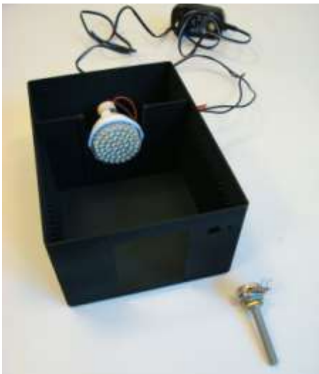
Abb. 2.2 (a) Box mit Lichtquelle und Widerstand zum Einbau. (b) Der eingebaute Widerstand im Gehäuse. Achte beim Einbau darauf, dass der kleine Stift auf dem Widerstand in das passende Loch rechts von der Achse gesteckt wird.
