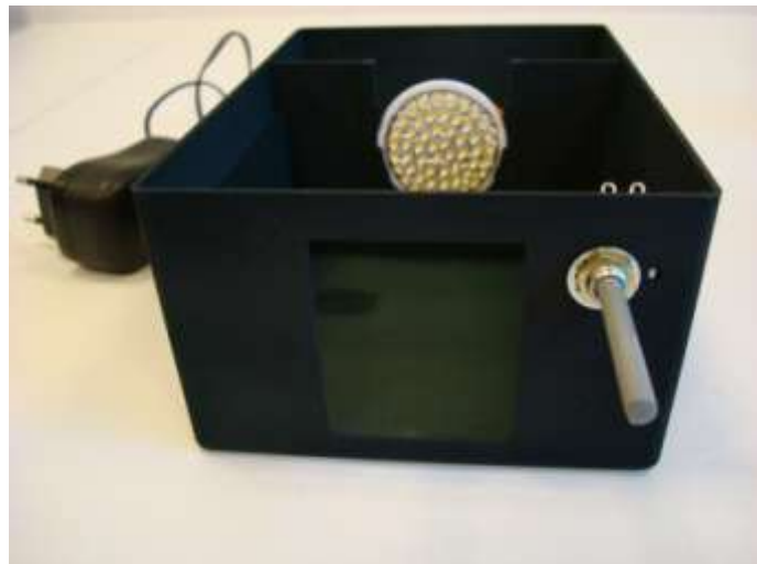
Abb. 2.2 (a) Box mit Lichtquelle und Widerstand zum Einbau. (b) Der eingebaute Widerstand im Gehäuse. Achte beim Einbau darauf, dass der kleine Stift auf dem Widerstand in das passende Loch rechts von der Achse gesteckt wird.
