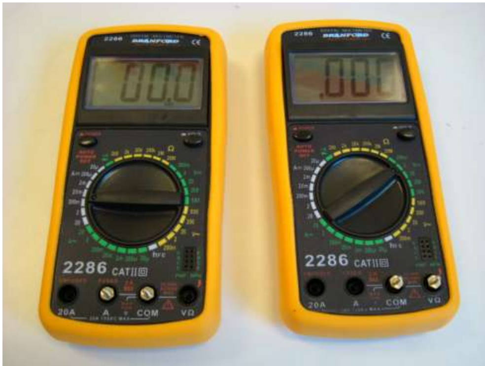
Abb. 2.3 Die Multimeter sind mit Anschlüssen für den Gebrauch als Voltmeter (rechts) bzw. Amperemeter (links) ausgestattet. Die Instrumente werden eingeschaltet, indem man links oben den „POWER“ Schalter drückt. Bei Nichtgebrauch schaltet sich das Messgerät nach einiger Zeit selbstständig ab. Das Multimeter kann Gleichstrom und Gleichspannung ( \equiv ), sowie Wechselstrom und Wechselspannung ( \sim ) messen. Der Innenwiderstand des Voltmeters beträgt über den gesamten Messbereich 10\text{ M}\Omega . Der Spannungsabfall des Amperemeters beträgt über den gesamten Messbereich 200\text{ mV} . Bei Bereichsüberschreitung (overflow) zeigt das Instrument die Ziffer „1“ und man muss einen größeren Messbereich wählen. Der „HOLD“-Taster sollte nicht betätigt werden, es sei denn, man will einen Messwert in der Anzeige festhalten.
